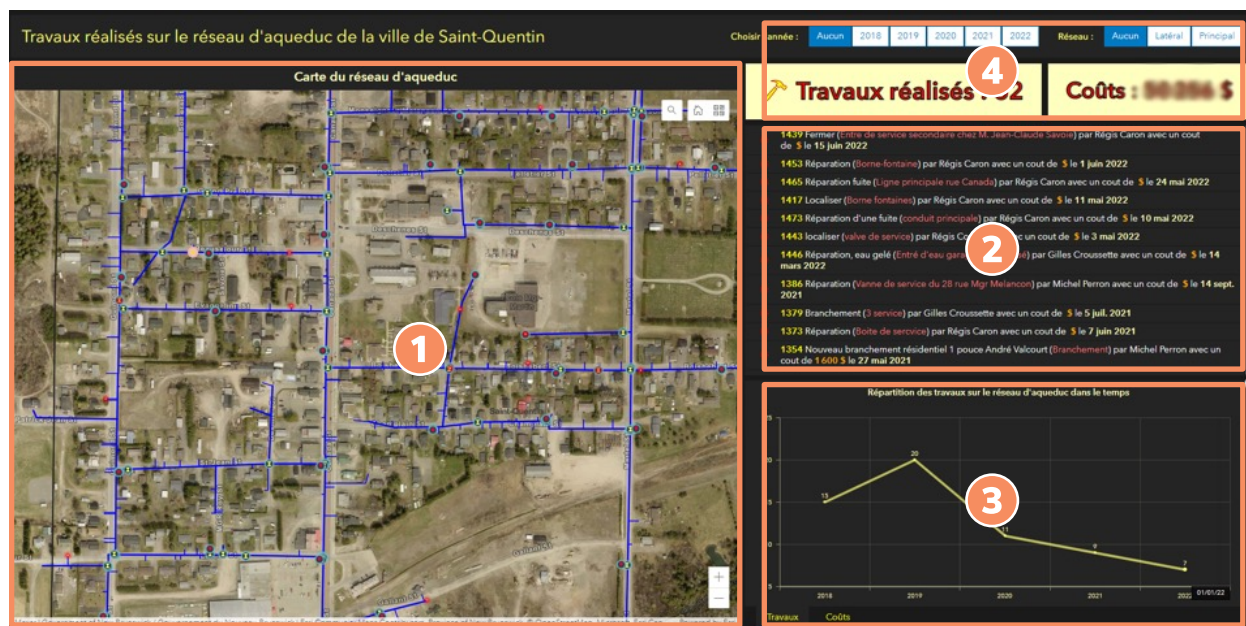
Figure 17 : Exemple de tableau de bord des travaux réalisés sur le réseau d'aqueduc
